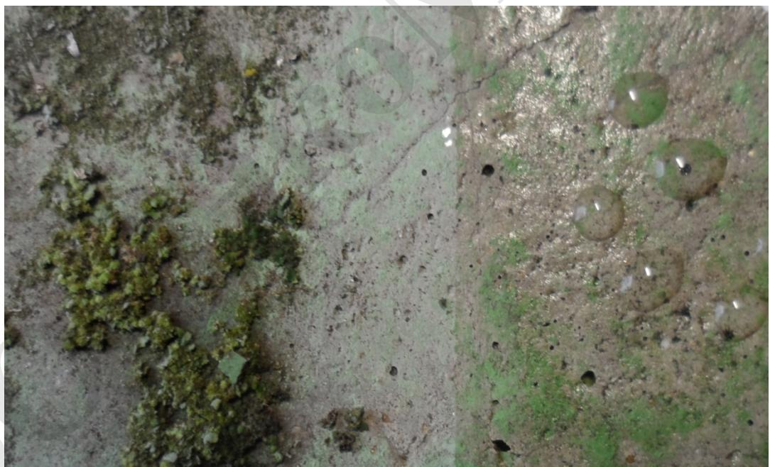
Фото. 7. Проверка качества гидрофобизации поверхности через 0,5 часа
